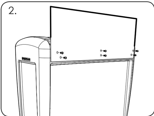
2. Coloque el soporte de carteles (Artículo 1) y alinee los seis orificios de fijación en la parte posterior de la unidad.
