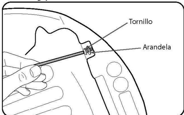
2 Retire el tornillo y la arandela de la cubierta (figura superior) con una llave allen.
