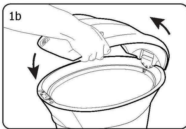
Situe la cubierta contra la pletina del borde superior de la papelera (figura 1a), al hacer pivotar la cubierta, la pletina encajará en el hueco de la cubierta (figura 1b).
