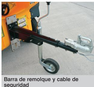
Barra de remolque y cable de seguridad
