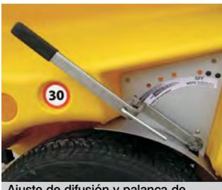
Ajuste de difusión y palanca de apagado
