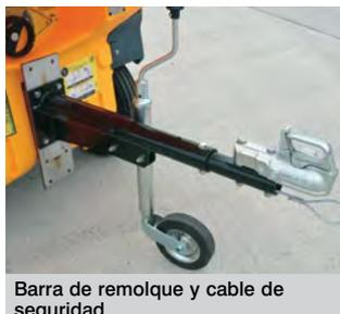
Barra de remolque y cable de seguridad
